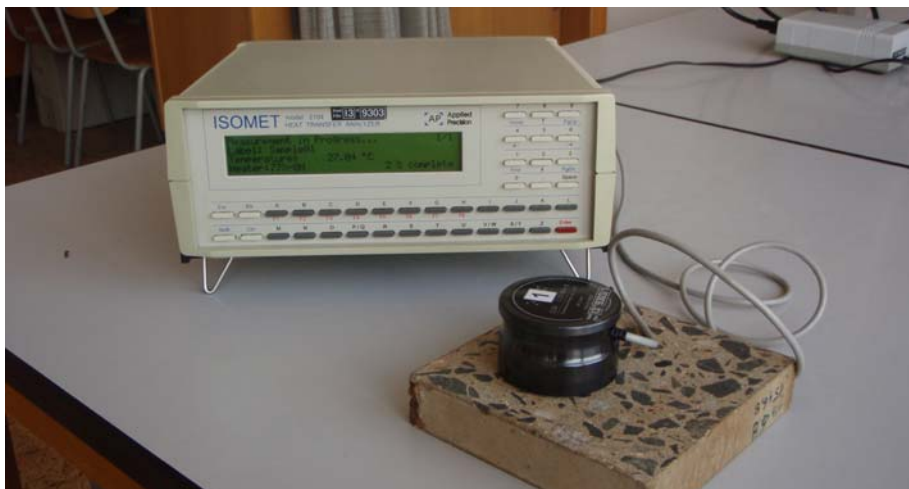
Obr 1. Měření pomocí přístroje Izomet 2104
