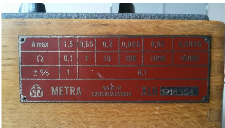
Obr. 2 Odporová dekáda a tabulka s údaji o třídě přesnosti
