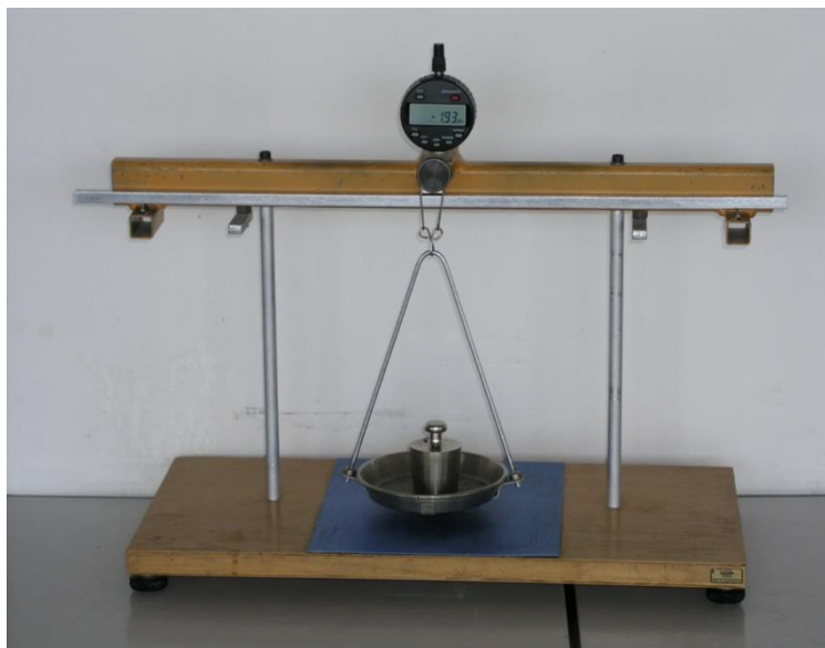
Obr. 2 Laboratorní sestava k měření průhybu tyče
