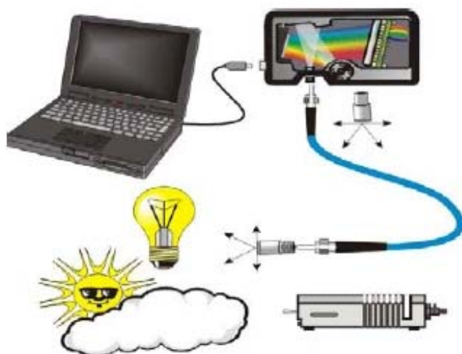
Obr. 2 – Schéma měření spektrálního složení světelných zdrojů
